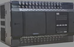
**CLP:** Controlador Lógico Programável: desempenha funções de controle e monitoramento de máquinas e processos industriais.
