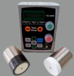
**Controlador de umidade:** solução moderna e eficiente que permite um controle preciso, em tempo real, da quantidade de água presente no concreto; mantém a relação água vs. cimento constante e proporciona automação da adição de água.
