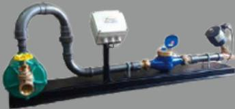
**Dosador de água e aditivo:** equipamento destinado a dosagem de água em diversos processos de fabricação, especialmente concreto, possui o princípio de dosagem por batelada, onde o medidor informa o CLP ou pré-determinador, através de pulsos, o volume de água escoado, operando a bomba e a válvula pneumática para início e termino da dosagem.
